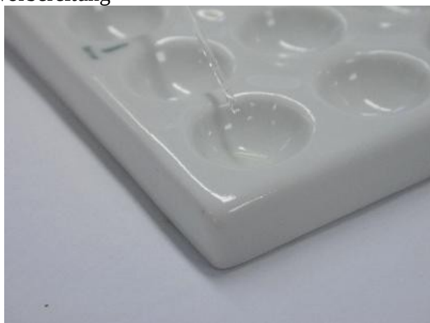
3. Ein Tropfen in Wasser gelöstes Thiocyanat (Ammonium- oder Kaliumthiocyanat) wird zu der
