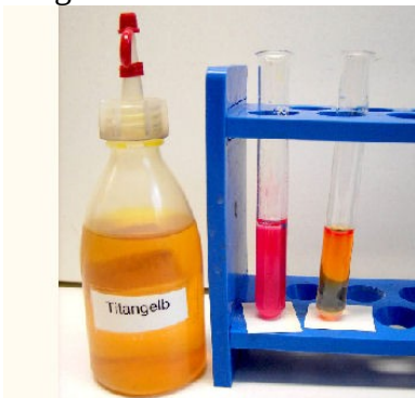
3. In Reagenzglas 1 und 2 gibt man je zwei Tropfen Titangelb-Lösung und einige Tropfen Natronlauge. Im
