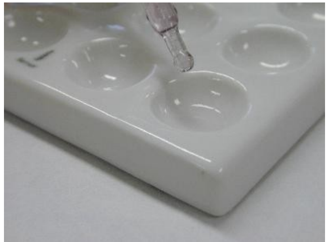
4. Zugabe von 1 - 2 Tropfen Lösung B (konz. \alpha -Naphthylamin in 30 proz. Essigsäure).
