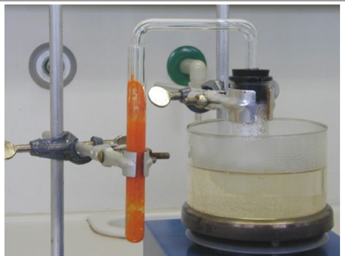
2. Beim Einleiten von \text{H}_2\text{S} -Gas in eine salzsaure Antimonlösung fällt orangefarbenes \text{Sb}_2\text{S}_3 aus.
