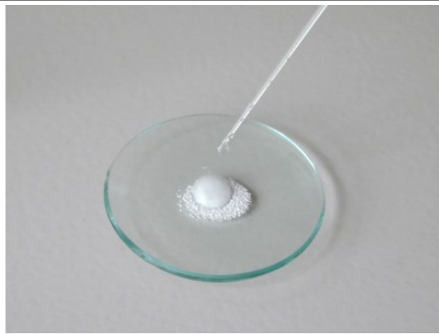
2. Die Probe wird in einigen Tropfen verdünnter Salzsäure gelöst
