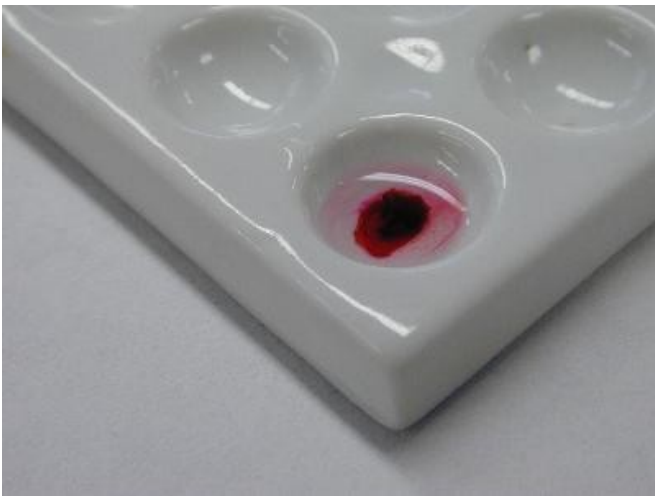
9. Nach etwa 2 Minuten zersetzt sich der rote Azofarbstoff unter Braunfärbung.
