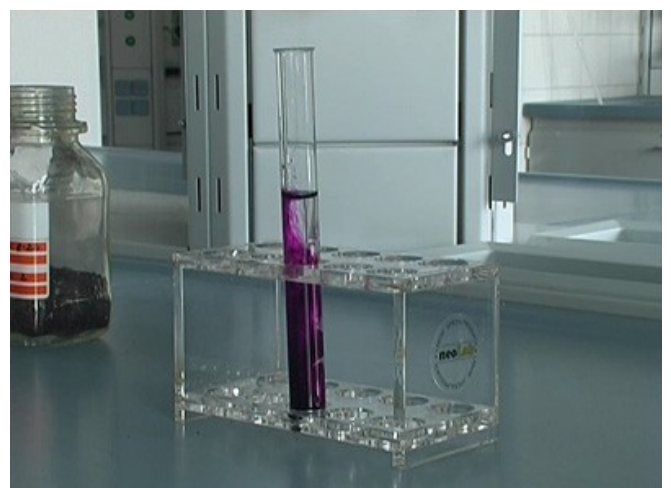
2. Ein Reagenzglas wird mit Wasser gefüllt und KMnO 4 als Kontrastmittel hinzugefügt.
