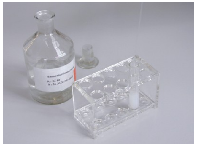
2. Beim Versetzen einer zinkhaltigen Lösung mit Ammoniakwasser fällt weißes \text{Zn}(\text{OH})_2 aus.
