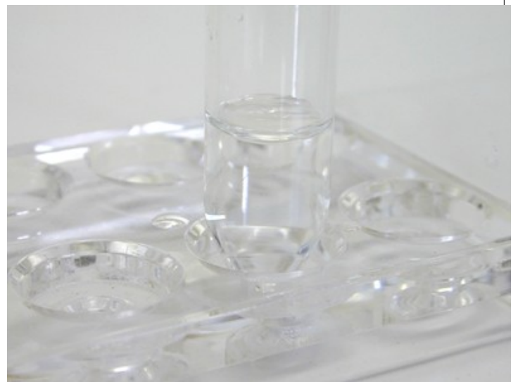
4. Der Rückstand löst sich in verdünnter Ammoniaklösung vollständig auf.
