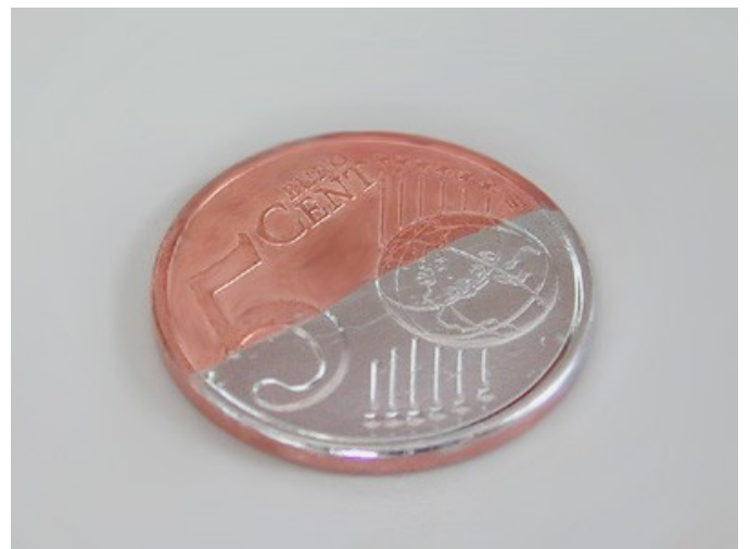
6. Bei Anwesenheit von Quecksilber bildet sich silberglänzendes Kupferamalgam.
