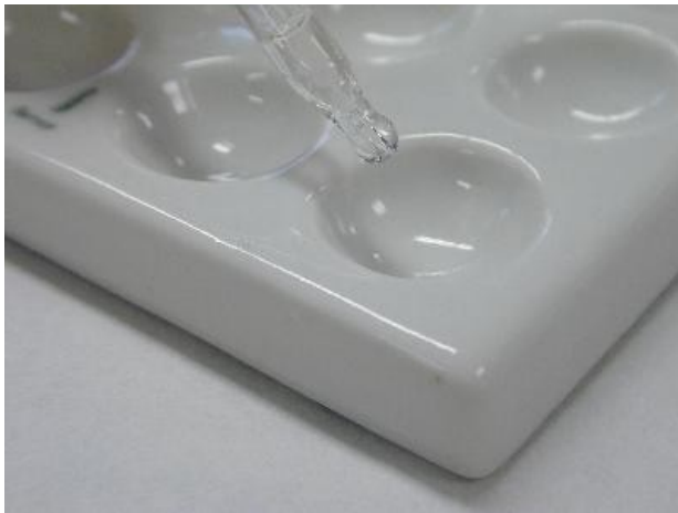
3. Zugabe von 1 - 2 Tropfen Lösung A (1 proz. Sulfanilsäure in 30 proz. Essigsäure).
