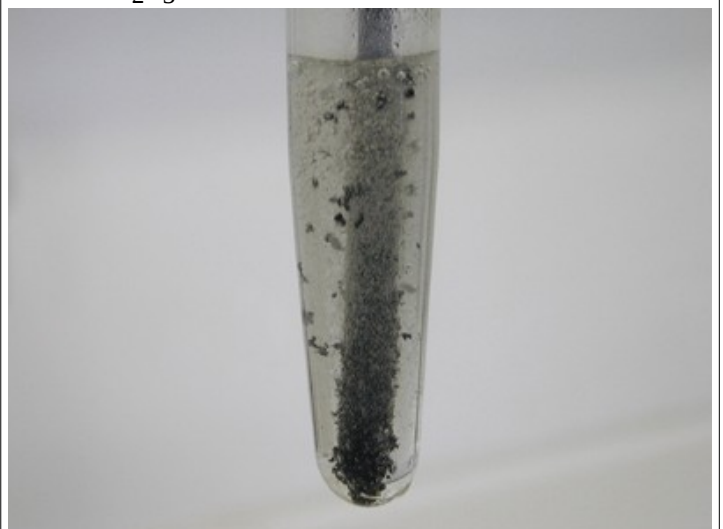
6. Antimon scheidet sich in schwarzen Flocken auf der Eisenoberfläche ab.
