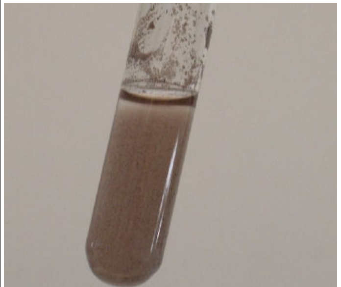
6. Bei weiterem Erhitzen fällt ein braunschwarzer Niederschlag von Arsen aus.
