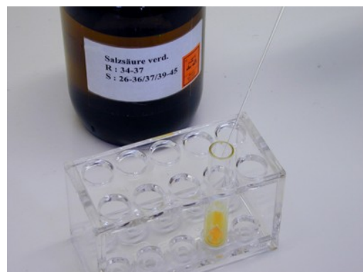
6. as Cadmiumsulfid wird abzentrifugiert und löst sich in verd. Salzsäure
