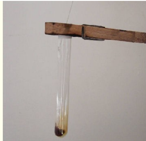
2, Festes Iodidsalz in ein trockenes Reagenzglas geben und mit einigen Tropfen konzentrierter Schwefelsäure versetzen.
