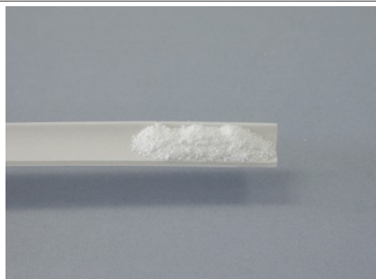
2. 3-5 der Analysenprobe werden mit dem zehnfachen Überschuss einer 1:1 Mischung aus \text{KNO}_3 und \text{Na}_2\text{CO}_3 vermengt und auf eine Magnesiumrinne gegeben
