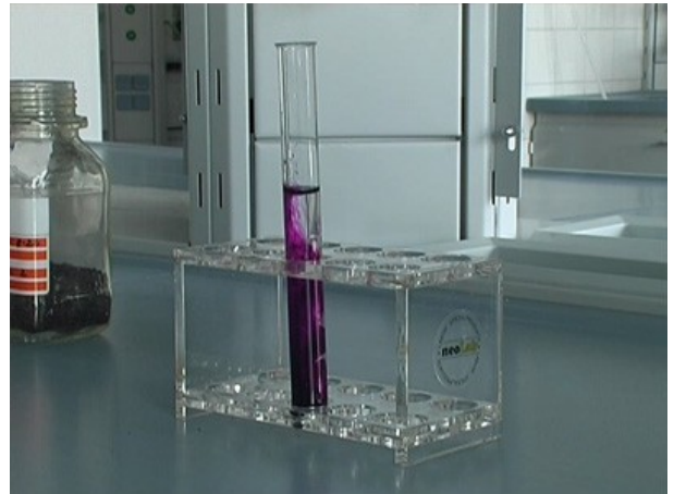
2. Ein Reagenzglas wird mit Wasser gefüllt und \text{KMnO}_4 als Kontrastmittel hinzugefügt.
