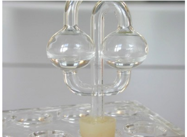
2. Ein Gärröhrchen wird in einen Gummistopfen gesteckt und mit klarer, gesättigter Bariumhydroxidlösung gefüllt.
