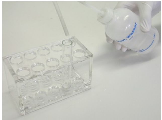
2. Der beim Lösen der Analyse in Salzsäure unlösliche, weiße Rückstand wird zunächst mit Wasser gewaschen.
