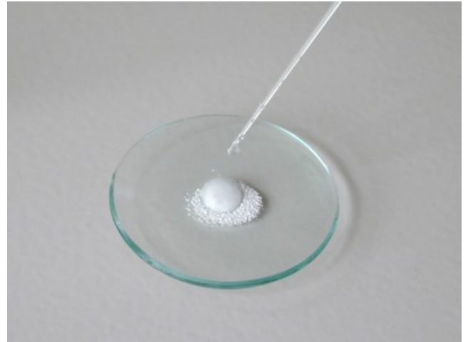
2. Die Probe wird in einigen Tropfen verdünnter Salzsäure gelöst.
