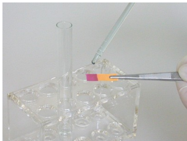
2. Die Lösung des Sodauszugs wird mit konz. Salpetersäure angesäuert.
