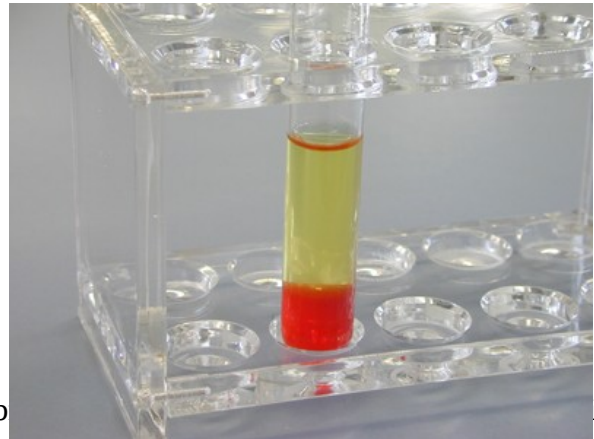
2. Die angesäuerte Lösung des Sodaextrags wird mit Chloroform unterschichtet.
