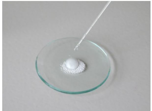
2. Die Probe wird in einigen Tropfen verd. Salzsäure gelöst
