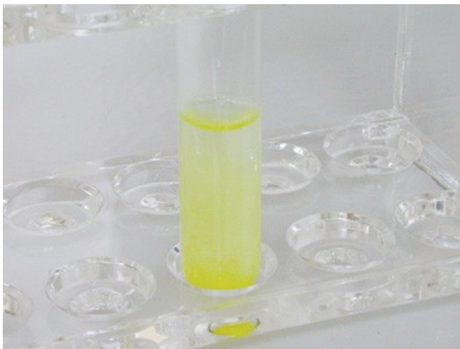
5. Es bildet sich ein gelber Niederschlag von Ammoniummolybdophosphat.
