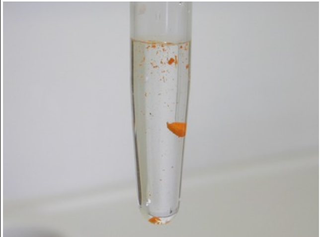
4. Das \text{Sb}_2\text{S}_3 löst sich in konz. Salzsäure.
