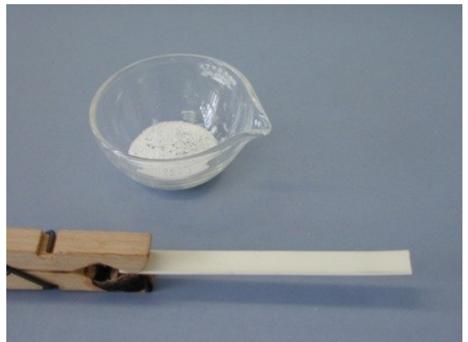
2. 3-5 der Analysenprobe werden mit dem zehnfachen Überschuss einer 1:1 Mischung aus \text{KNO}_3 und \text{Na}_2\text{CO}_3 vermengt.
