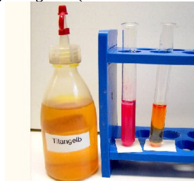
In Reagenzglas 3 und 4 zehn Tropfen Magneson-Lösung und einige Tropfen Natronlauge geben. Im
